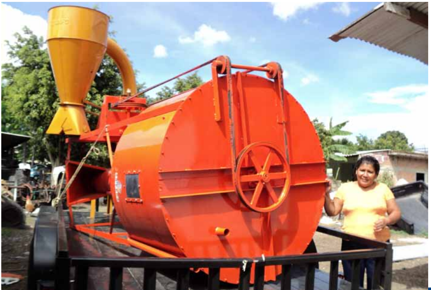
Máquina para mezclar, picar y moler alimento para el ganado.
